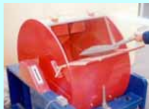
①土入れ（投入口の高さ調節可！）
